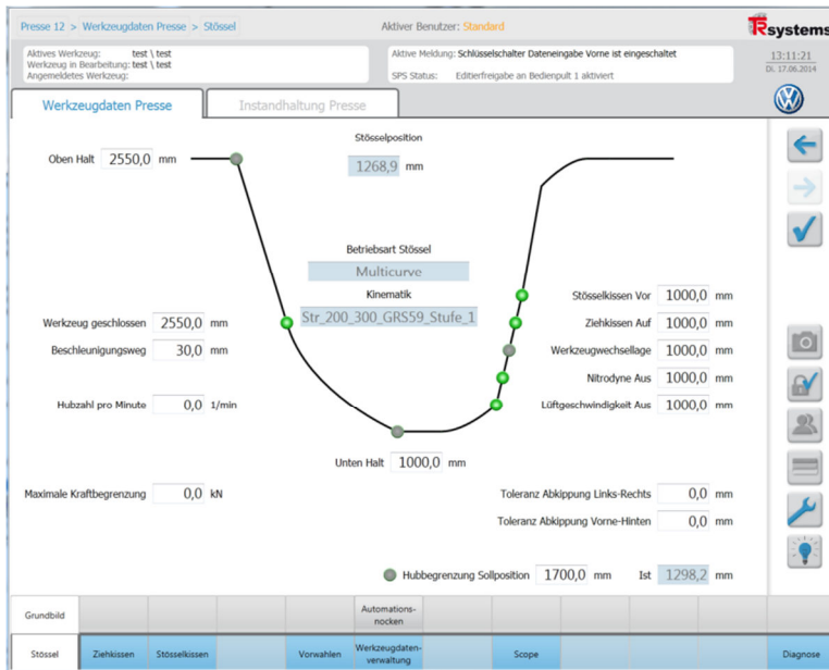
Grafik 3 Bildschirmansicht Visualisierung TRproVi: Stößel-Grundbild einer Multicurve-Pressen (Quelle: TRsystems GmbH)
